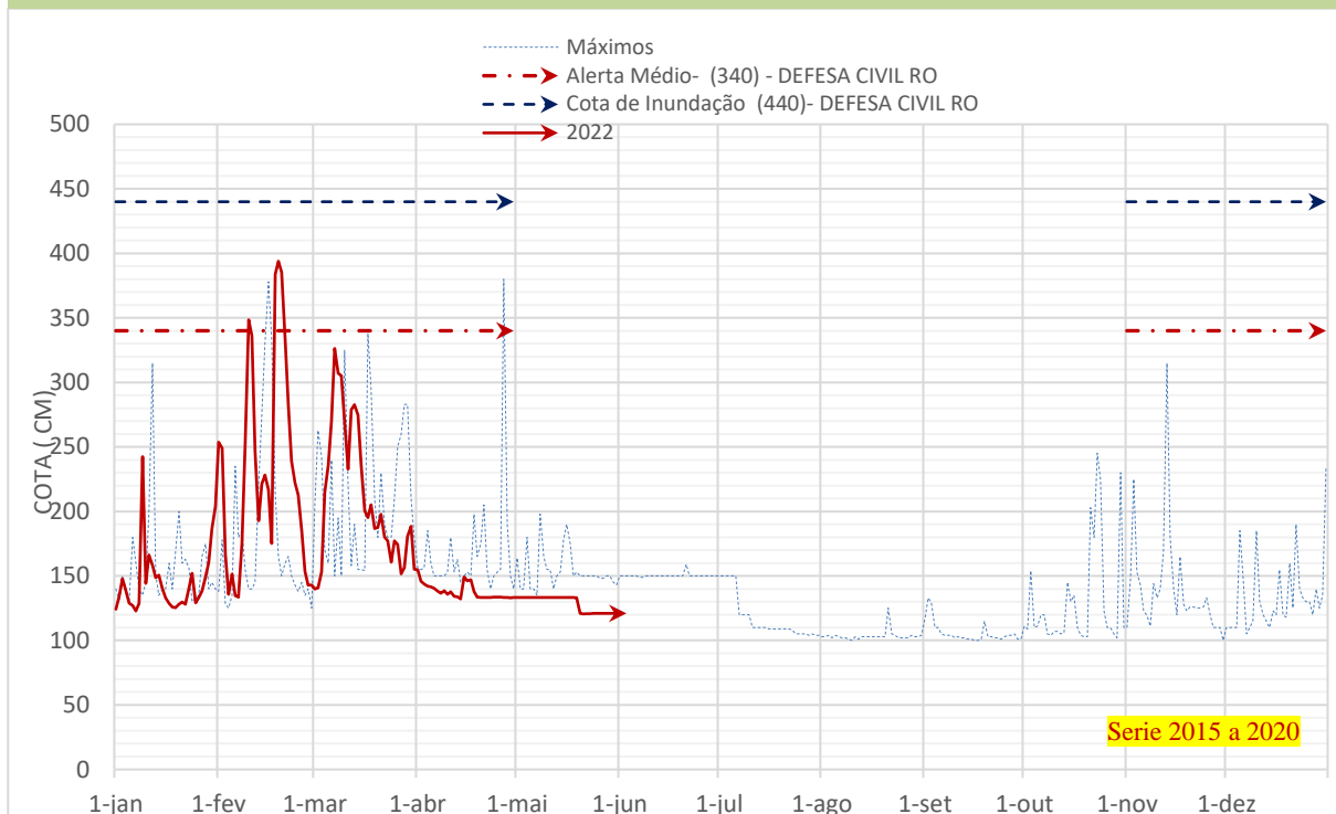
Gráfico 7- Monitoramento diário da cota do rio Machado, na coordenada geográfica de latitude -11,44 leste e longitude - 61,4408 oeste, em Cacoal/RO. ANÁLISE TÉCNICA
